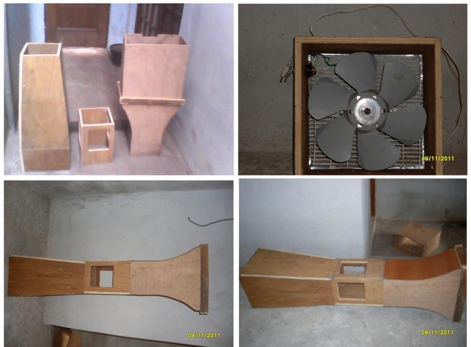
Figura 2. Imagens da construção do mini túnel de vento.
