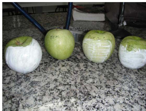
Figura 3 – Amostras para teste antes de serem submetidas a simulação de radiação UV.
